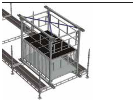
15. Monter øverste horisontalstag med Ø16x90mm Clevis dorne og splitter.
