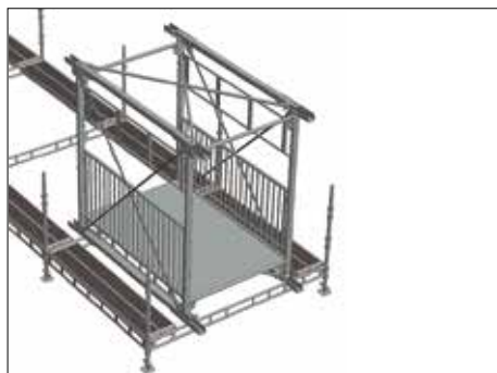
17. Fjern alle midlertidig m-hegn og montageplatformen. Brug disse komponenter ved montering af næste fag af HBS.
