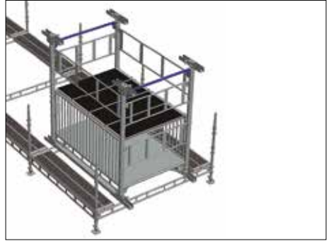
13. Montera övre enrörsbalkar mellan pelarnas ovan delar.
